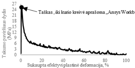
78 pav. AISI304L nerūdijančio plieno izotropinio kietėjimo kreivė, apskaičiuota esant 0,3 % deformacijos amplitudei 300 °C temperatūroje (naudojama Ansys modelyje)
