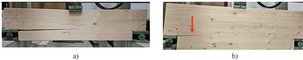
Figure 5 Predominant failure modes of solid timber (a) and glulam timber (b) Slika 5. Prevladavajući načini loma punog drva (a) i lijepljenoga lameliranog drva (b)
