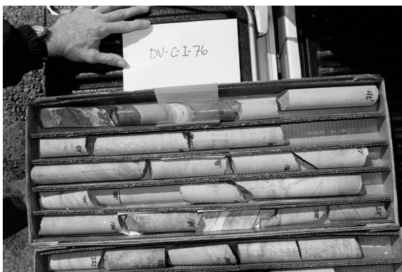
3.3 pav. Vamzdiniu grąžtu išgręžti akmens uolienuų kernai; jie sudėti paėmimo tvarka ir nurodyti jų slūgsojimo gyliai (a); kernų gręžimo grąžto galvutės (b)
