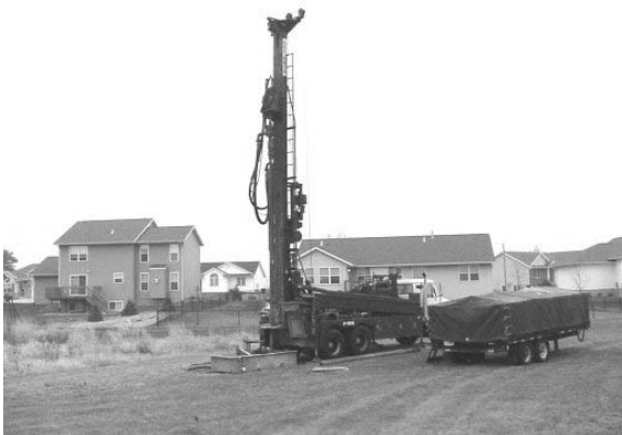
3.4 pav. Kilnojamas geologinis gręžimo įrenginys:
