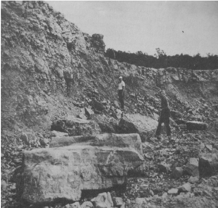
1.4 pav. Petrašiūnų II karjerodolomito kledo apatinio sluoksnio dolomito blokai, tinkami apdailos plokštėms [1]
