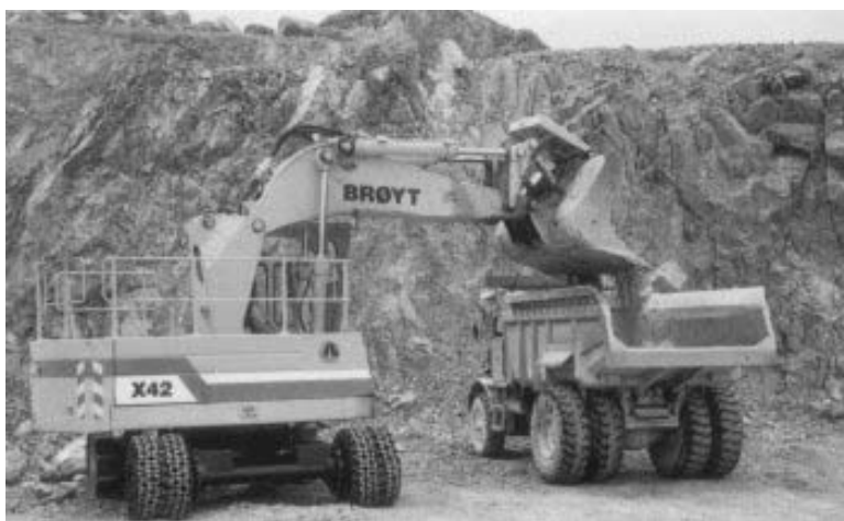
6.7 pav. Automobilių pakrovimas karjere
