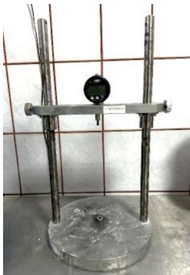
17 pav. Susitraukimų matavimo bandymo prietaisas
