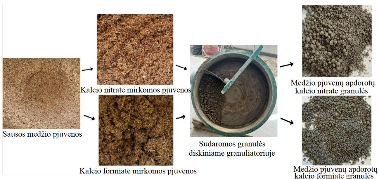
22 pav. Dirbtinio užpildo, naudojant kalcio nitrata ir kalcio formiatą, gamybos schema
