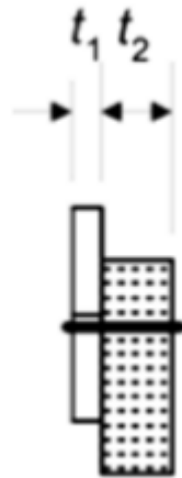
27 pav. Principinė varžtinės jungties schema [23]
