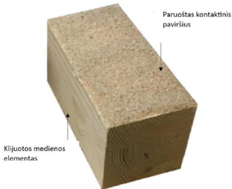
2 pav. Bandinys su epoksidiniais kljais ir kvarciniu smėliu [3]
