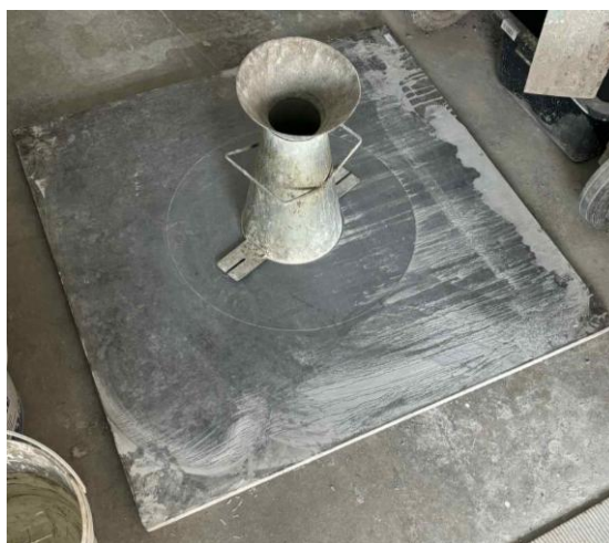
7 pav. Pasklidimo bandymo kūgis ir padėklas su 500 mm skersmens žyme
