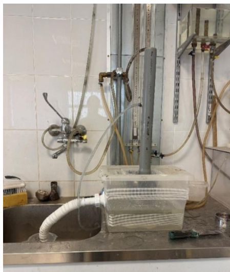
14 pav. Vertikalaus vandens pralaidumo nustatymo prietaisas
