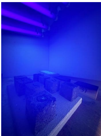
17 pav. Bandinių laikymas UV spintoje
