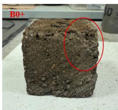
43 pav. Bandiniai po atsparumo šalčiui tyrimo
