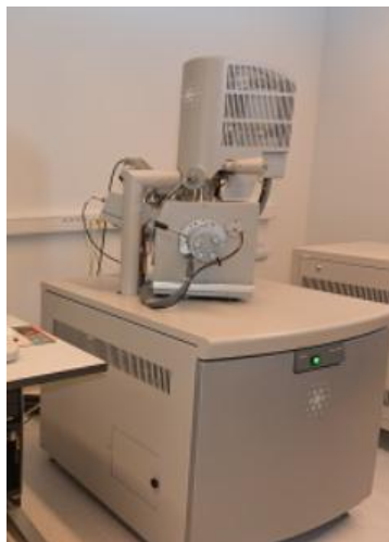
11 pav. SEM: Skenuojantis elektroninis mikroskopas – FEI Quanta 200 FEG [45]
