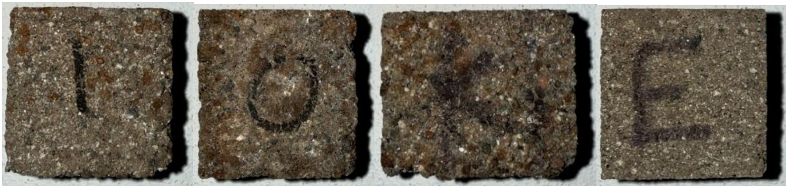
34 pav. Bandiniai po atsparumo UV spinduliuotei tyrimo (10 parų): sudėtis B30, B10+, B20+, B30+
