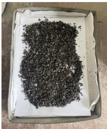
20 pav. 2/5 fr. granito atsijos padengtos SikaControl® E-150 emulsija
