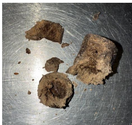
26 pav. Gyslotis + vanduo mišinio bandinys po sugniuždymo
