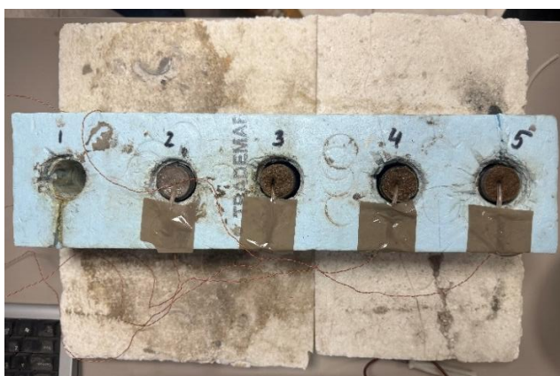
19 pav. Pusiau adiabatinio kalorimetro tyrimas
