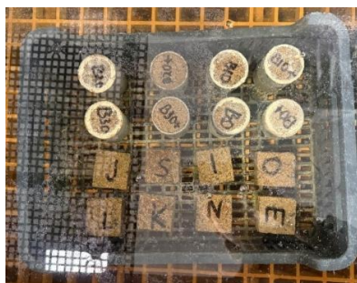
18 pav. Bandinių mirkymas vandenyje
