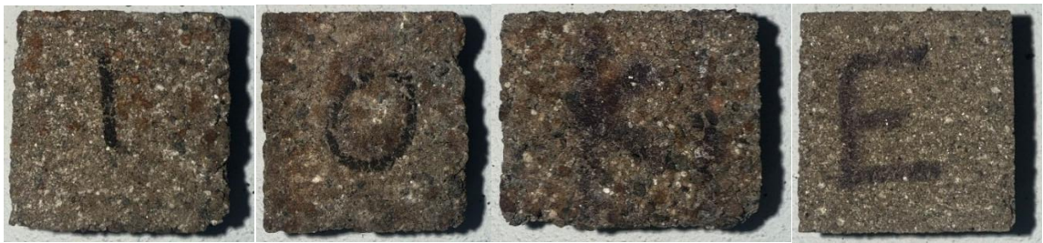
33 pav. Bandiniai prieš atsparumo UV spinduliuotei tyrimą: sudėtis B30, B10+, B20+, B30+
