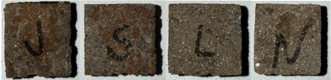
32 pav. Bandiniai po atsparumo UV spinduliuotei tyrimo (10 parų): sudėtis B0, B0+, B10, B20
