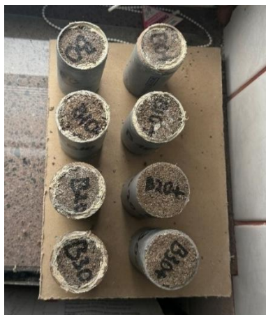
15 pav. Cilindrinių bandinių paruošimas vandens pralaidumo bandymui
