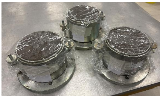
10 pav. Bandiniai CBR tyrimui
