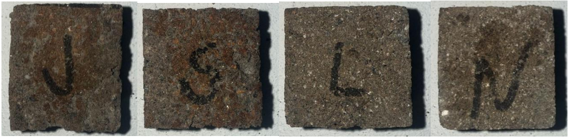
31 pav. Bandiniai prieš atsparumo UV spinduliuotei tyrimą: sudėtis B0, B0+, B10, B20
