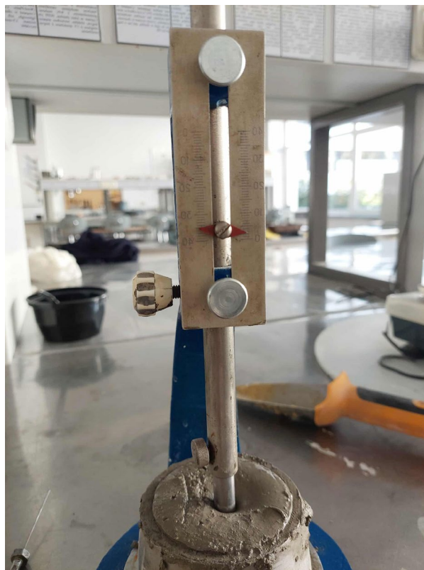
6 pav. Normalios tešlos konsistencijos nustatymo bandymas
