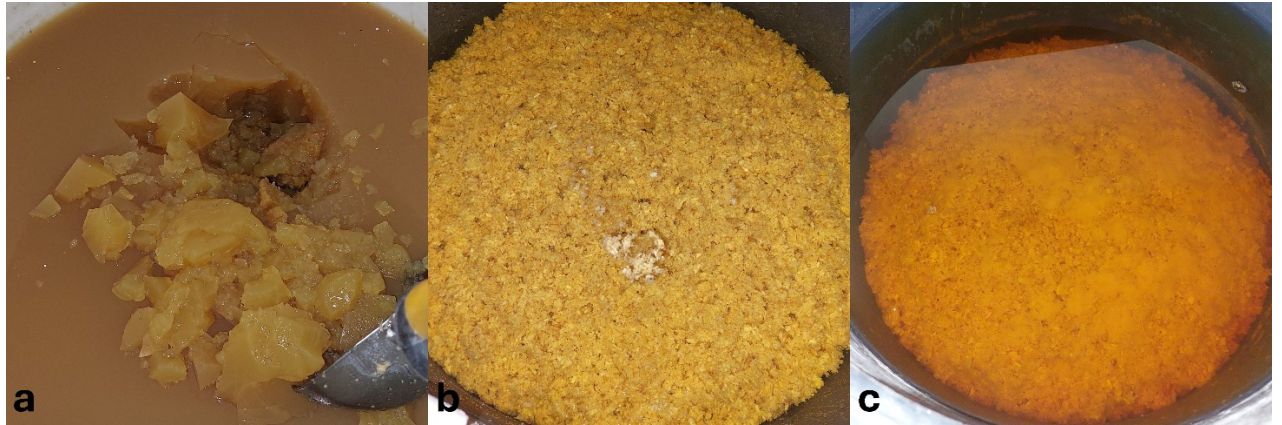
3 pav. Pjuvenų apdirbimo mišinys SS+GK (a), NH+GK (b), SS (c).
