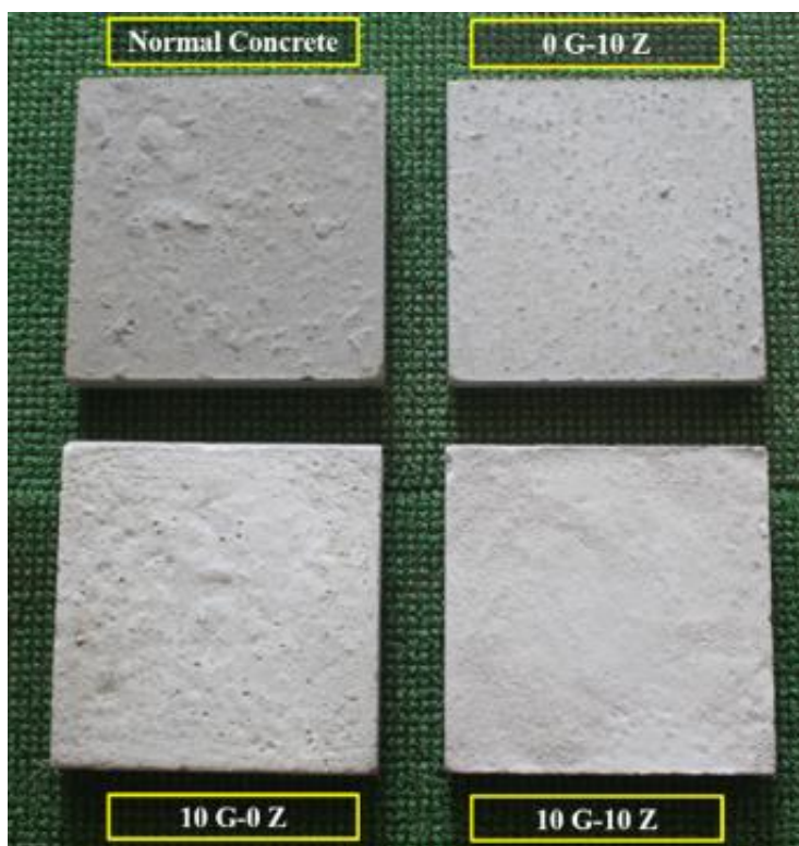
18 pav. Betono su malto stiklo ir ceolito bandinių spalvos palyginimas [39]
