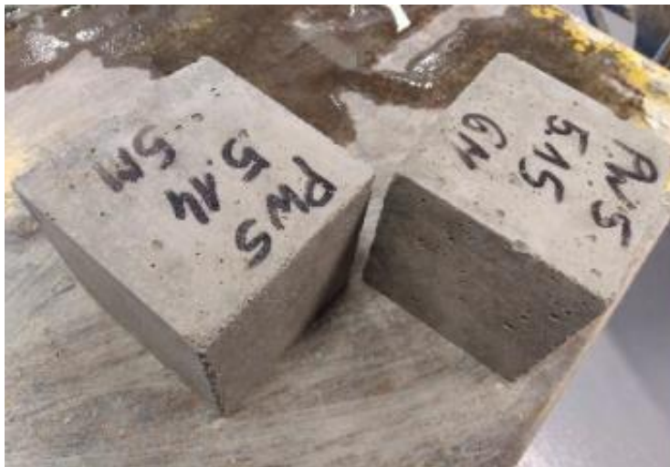
15 pav. Betono su 22,5 % malto stiklo bandiniai po 100 užšalimo ir atšilimo ciklų (F100) [33].
