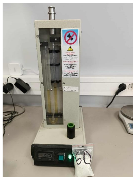
34 pav. Malto stiklo dalelių dydžio matavimo procesas Bleino aparatu
