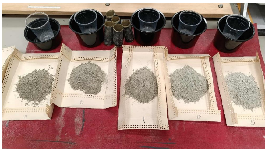
35 pav. Portlandcemenčio su maltu stiklu paruošimas hidratacijos proceso tyrimui
