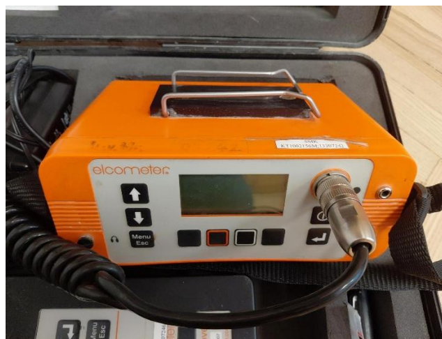
25 pav. Elcometer 331 potencialo matuoklis
