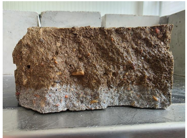
24 pav. Chloridų įsiskverbimas į bandinį
