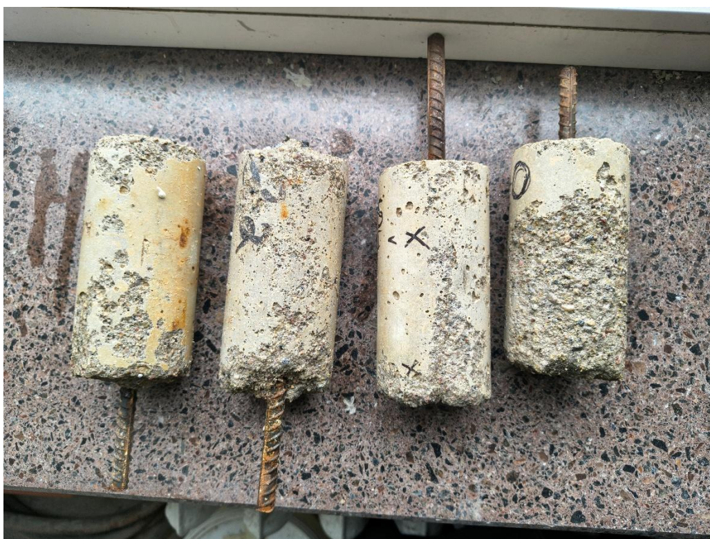
26 pav. Nuvalyti bandiniai, po 14 dienų šaldymo ir šildymo ciklų
