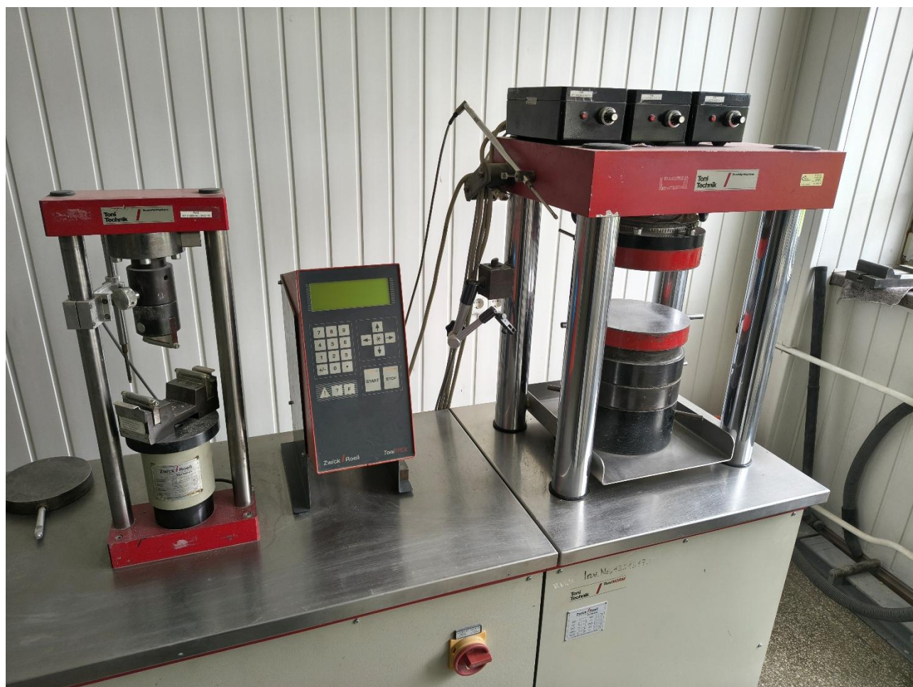
15 pav. Lenkiamojo ir gniuždomojo stiprio nustatymui naudotas aparatas „Toni Technik“
