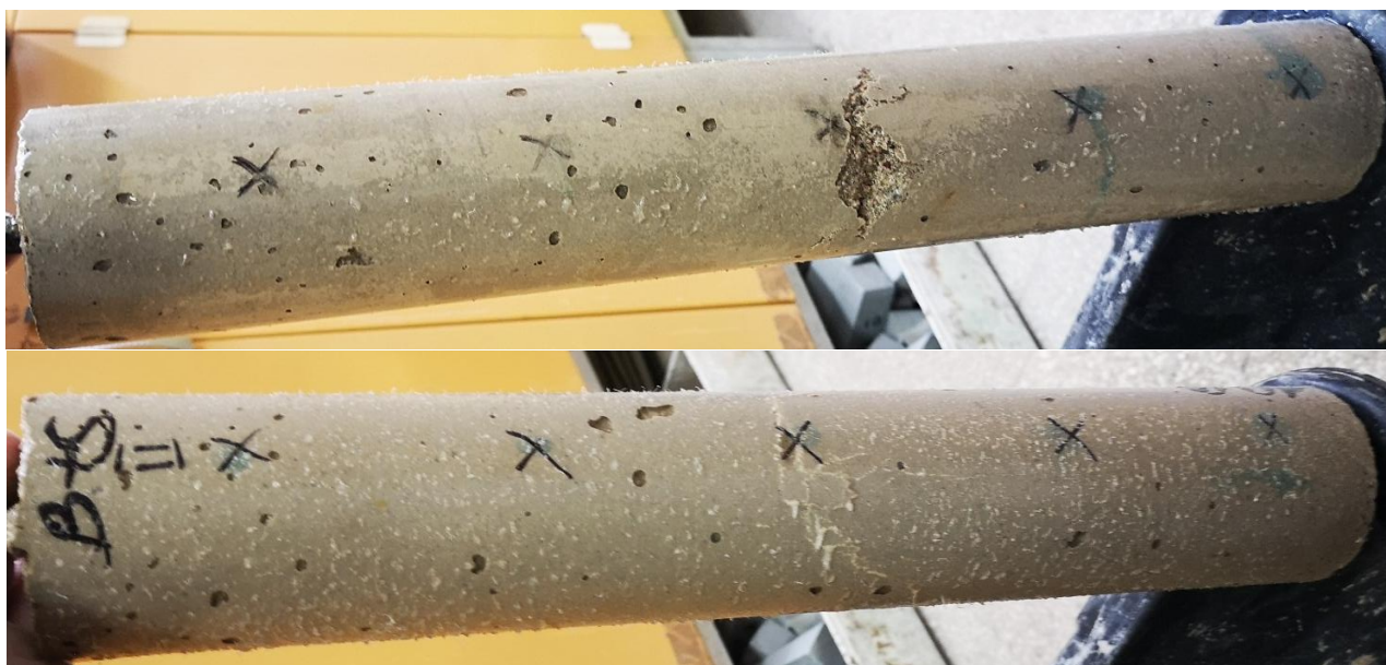
19 pav. Skirtingos potencialo matavimo vietos ant bandinių 1-B+S (viršuje) ir 2-B+S (apačioje)
