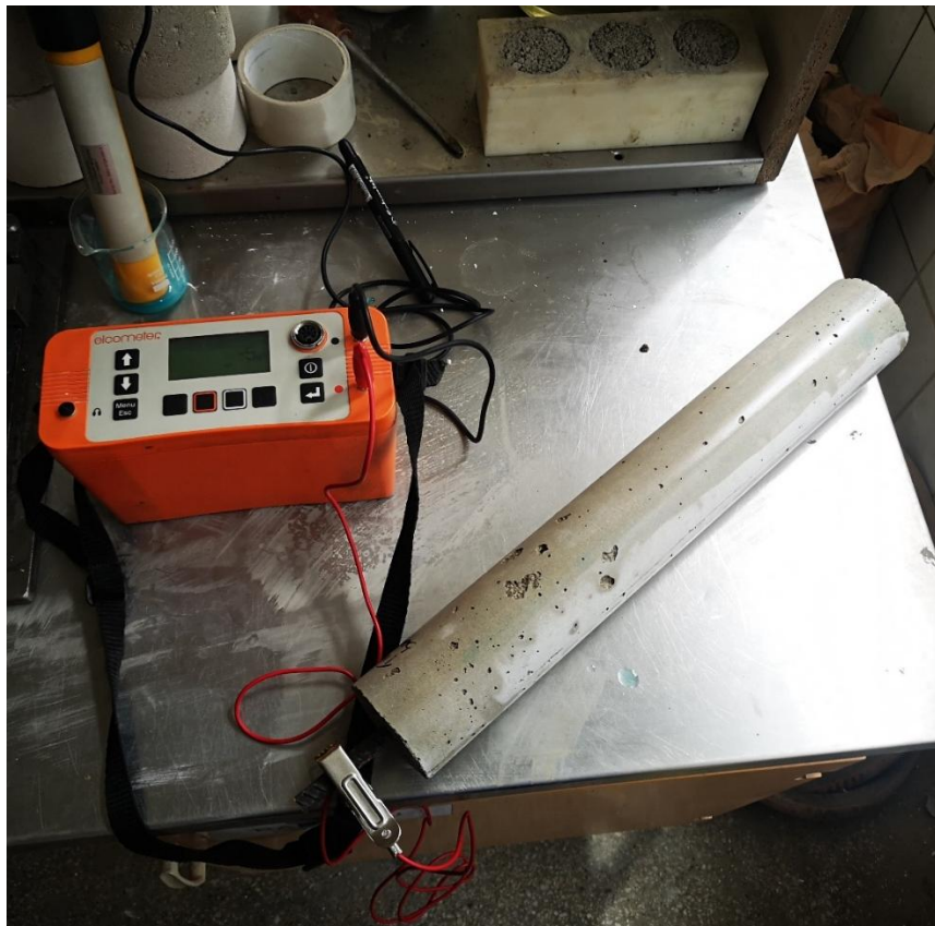
17 pav. Potenciometrinų matavimų procesas
