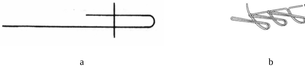
37 pav. Naudoti dygsniai ir siūlė: a – 6.02.01 tipo siūlė, b – 103 tipo dygsnį [37, 38]
