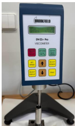
23 pav. Rotacinis viskozimetras Brookfield DV-II+ Pro, naudotas polimerinių tirpalų klampos tyrimams
