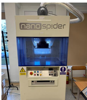
17 pav. Elektrinio verpimo „Nanospider™“ įranga
