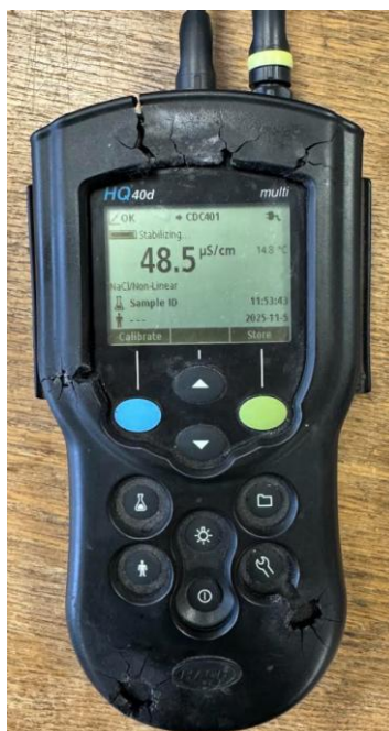
24 pav. Daugiafunkcis HQ40D multimetras su laidumo elektrodu, naudotas tirpalų elektrinio laidumo matavimams
