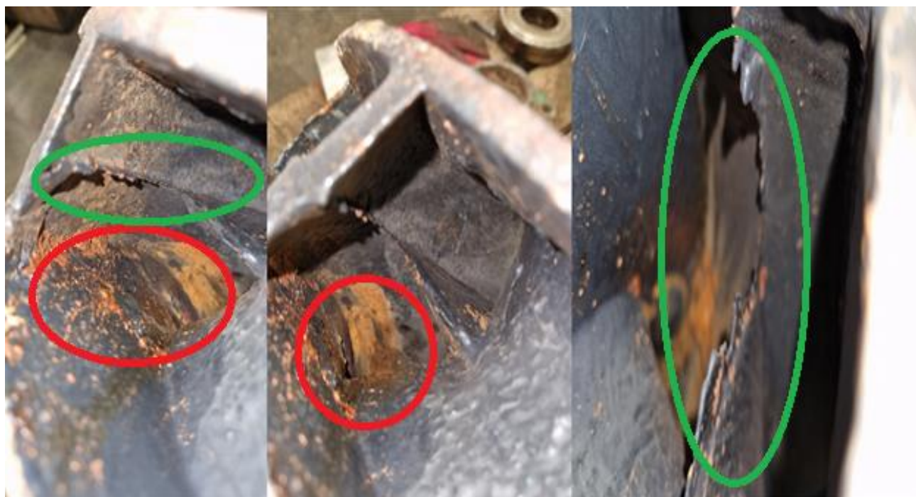
19 pav. Mažojo siurblio darbo rato sparnuotės korozija (raudonai) ir erozija (žaliai)
