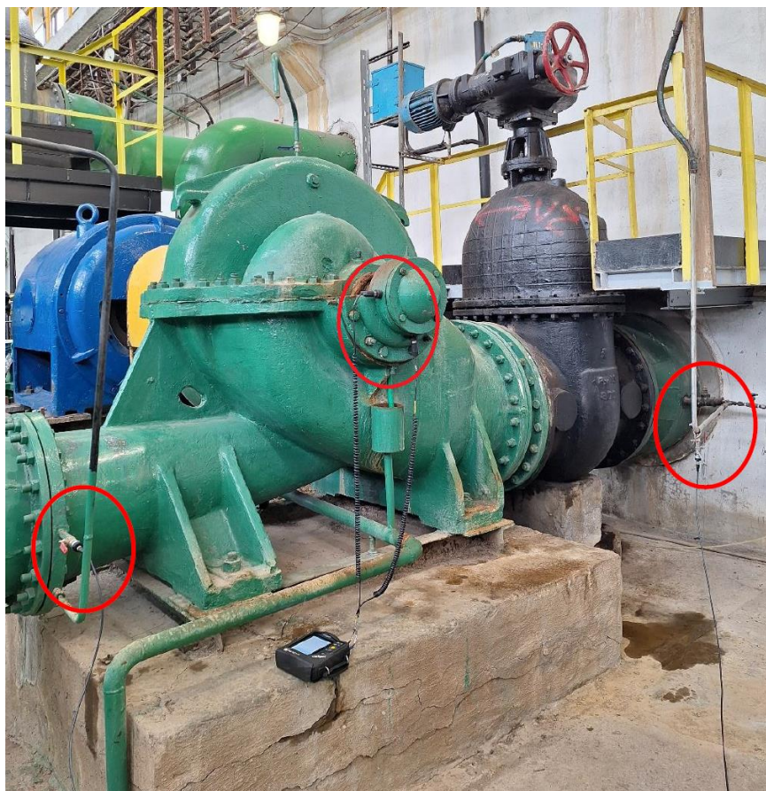
14 pav. ŠVS-1 siurblio slėgio ir vibracijų matavimas
