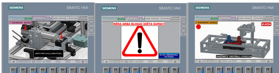
37 pav. HMI ekrano būsenos: A – instrukcija, B – klaida, C – pakartojimas
