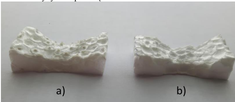
3.23 pav. PP nuotraukos po 40 s aukštos temperatūros poveikio eksperimento ( 160 \pm 2,5 °C): a) PP su SiO 2 priemaišomis, įterptomis į tūrį, b) PP be priemaišų
