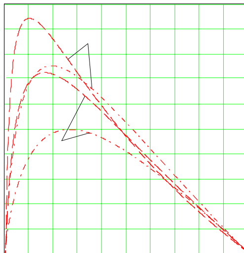
2 pav. Variklio naudingumo koeficiento priklausomybė nuo slydimo atsižvelgiant į maitinimo grandinės nuostolius: 1 – \theta_0=20^\circ\text{C} ; 2 – \theta_0=200^\circ\text{C} ; rotoriaus medžiaga: - - - - plienas (Cr 3), --- Fe-Cu lydinys (CM – 25)
