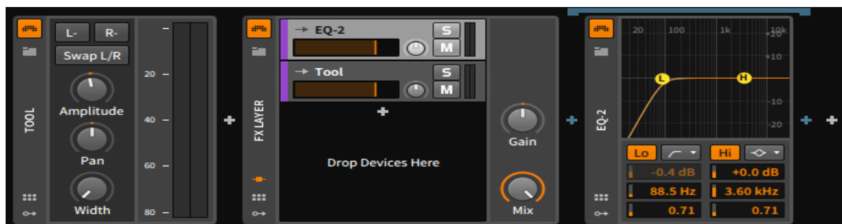
20 pav. Pirmasis signalo padalijimas EQ-2 žemo LO dažnio pjūvis iki 88,5 Hz.
