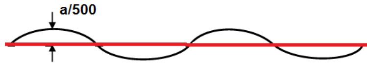
9.1 pav. Arkos konstrukcijos maksimalūs įlinkiai horizontalioje plokštumoje
