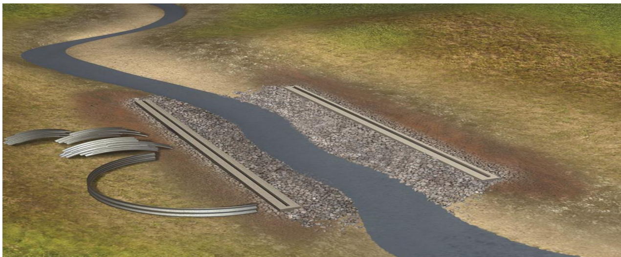
32 pav. Gofros lakštų surinkimas ant žemės
