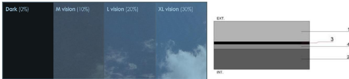
Pav. Nr. 9 Amorfinio silicio stiklas. 1) išorinis grūdintas stiklas; 2) vidinis grūdintas stiklas; 3) PV elementas (amorfinio silicio plėvelė); 4) laiminavimo plėvelė (Polivinilbutiralis arba Etileno vinilacetatas)[33], [32].
