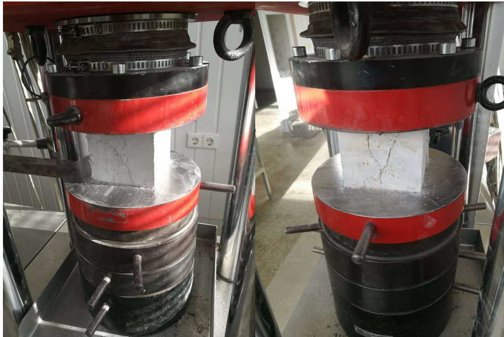
2.6.1 pav. Bandinių gniuždymas
