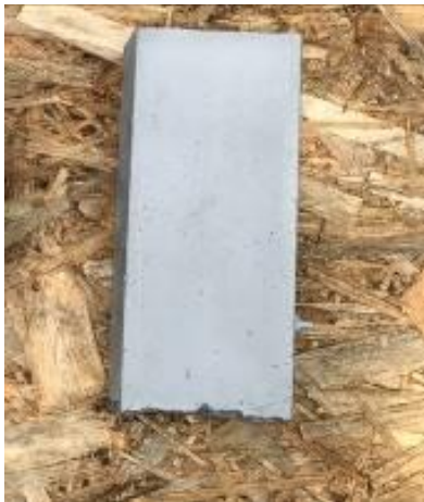
2.2.3 pav. Srautinio apdirbimo būdu gautas plieno paruošimo lygis buvo Sa 3
