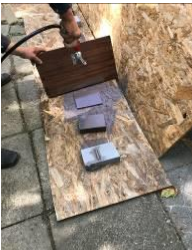
2.3.5b pav. Plieno bandinių paviršiaus dažymo procesas
