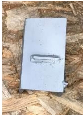
2.2.3 pav. Srautinio apdirbimo būdu gautas plieno paruošimo lygis buvo Sa 3
