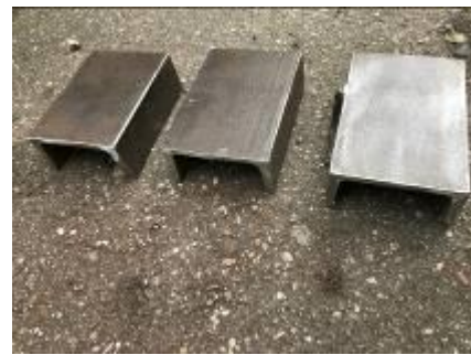
2.2.5 pav. Mechaninio apdirbimo būdu gautas paruošimo lygis buvo St 2
