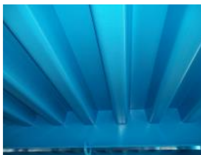
Metalizuotas paviršius padengtas 3 sluoksnių dažymo sistema
