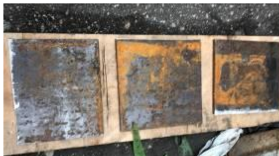
2.2.6 pav. Jokiais būdais neapdirbti plieno bandinių paviršius
