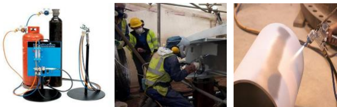
1.7.4 pav. Liepsninio metalizavimo vaizdas [41]
