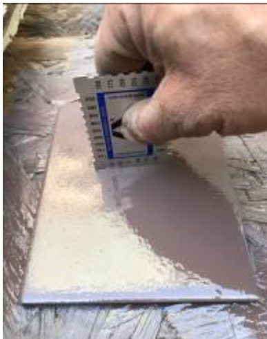
2.3.5a pav. Plieno bandinių paviršiaus dažymo procesas
