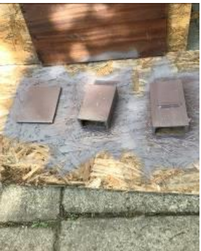
2.3.5b pav. Plieno bandinių paviršiaus dažymo procesas
