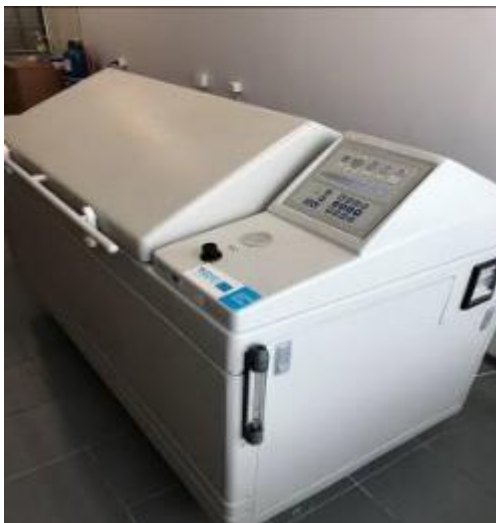
3.4.1 pav. Dažų sistemų ilgaamžiškumo bandymas druskos rūko kameroje
