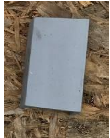
2.2.3 pav. Srautinio apdirbimo būdu gautas plieno paruošimo lygis buvo Sa 3
