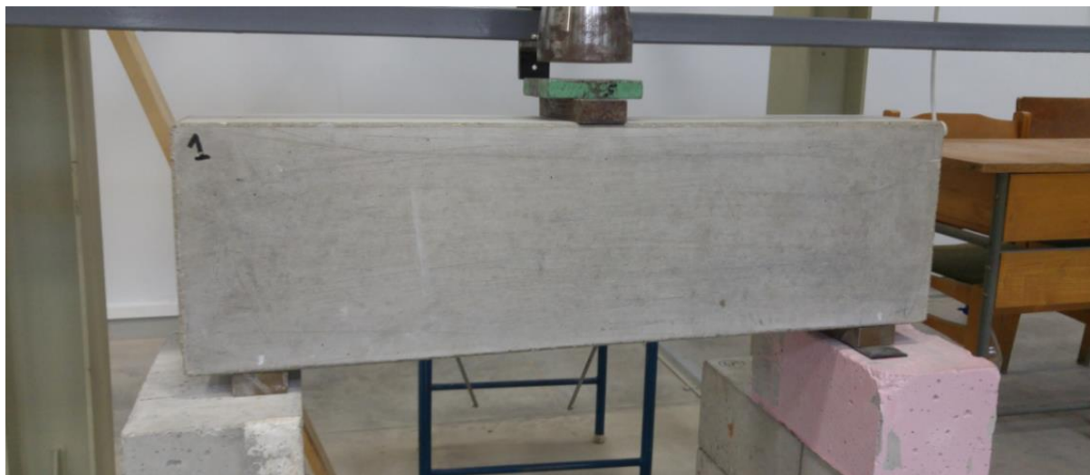
4.3.4.1. pav. Sijos stiprumo bandymas (stiklo pluošto armatūra(1)).
