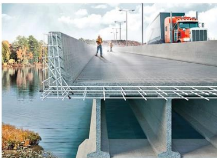
4.1.4. pav. Kompozitinės armatūros panaudojimas tiltų paklotų laikančioms konstrukcijoms.
