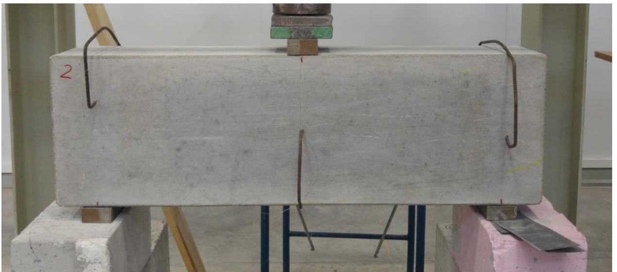
4.3.4.4. pav. Sijos stiprumo bandymas (stiklo pluošto armatūra(2)).
