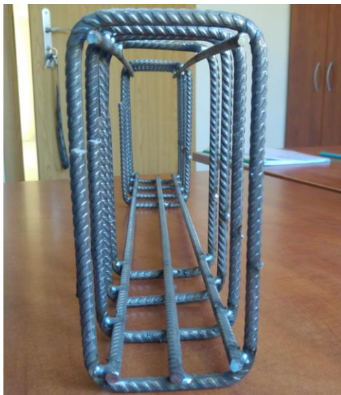
4.3.1.1. pav. Bandinio armuoto plienine armatūra strypų išdėstymas
