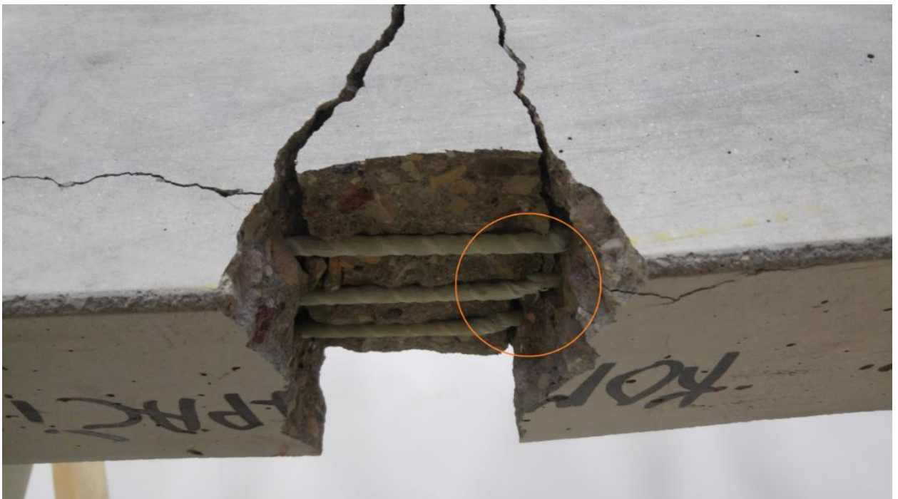
4.3.4.6. pav. Sijos suirimas. Nutraukta kompozitinė armatūra.
