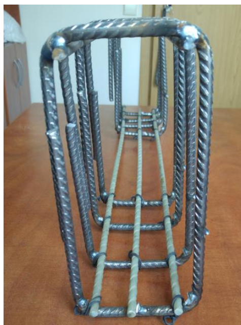
4.3.3.2. pav. Bandinio armuoto kompozitine (stiklo pluošto) armatūra strypų išdėstymas.
