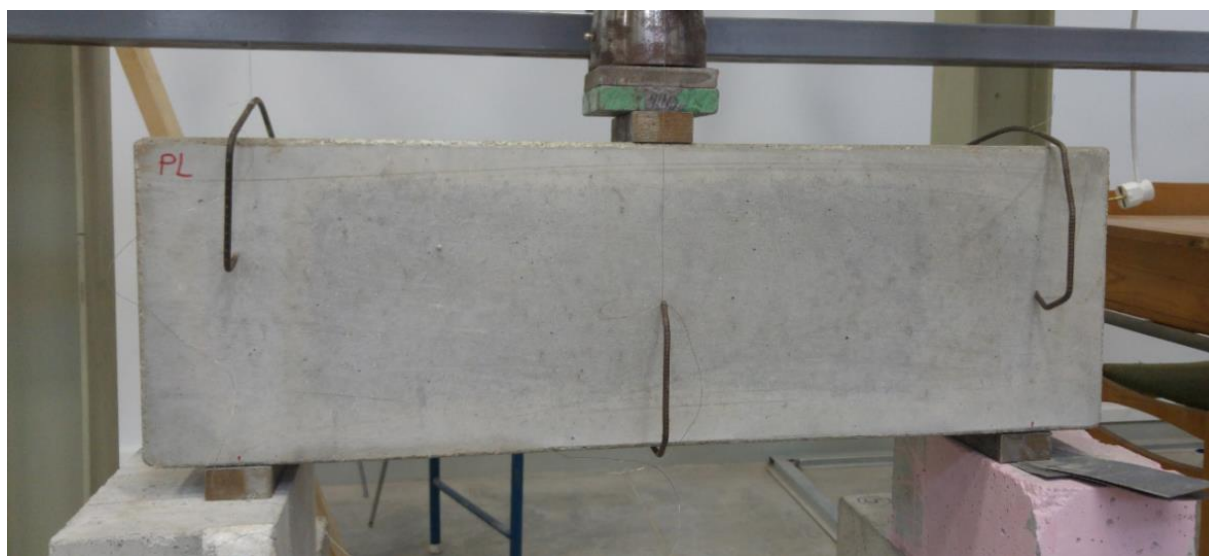
4.3.2.2. pav. Sijos stiprumo bandymas (plieninė armatūra).
