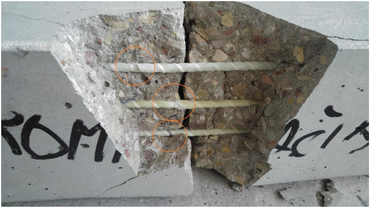
4.3.4.3. pav. Sijos suirimas. Nutraukta kompozitinė armatūra.
