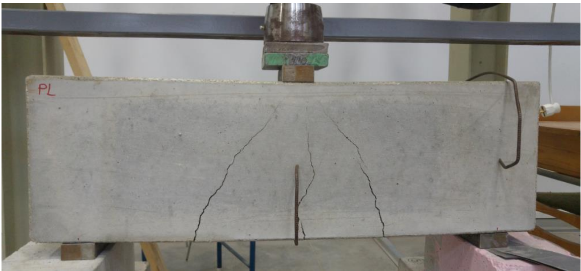
5.1.3. pav. Armatūros ir betono sukibimas nėra prarastas (plieninė armatūra).
