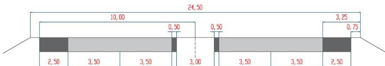
2.2 pav. Valstybinės reikšmės I kategorijos kelio skersinis profilis (21): ■ – asfalto arba betono danga, ■ – kraštinės saugos arba sustojimo juostos
