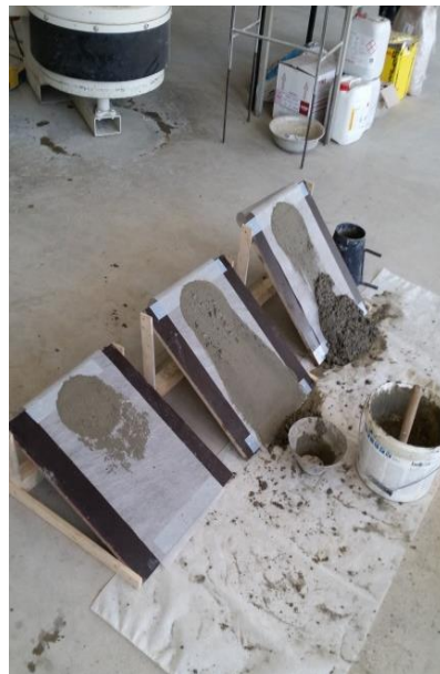
Betono mišinio bandinys, esant plokštumos posvyrio kampui 45°
