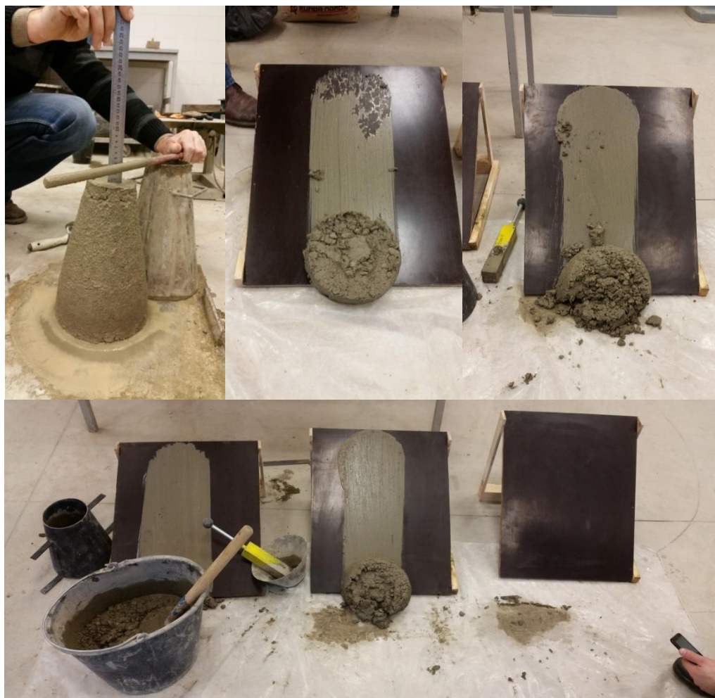
59 pav. Betono mišinio su polipropileno plaušu pastovumo ant 25°, 35° ir 45° pasivirusios nuožulnios plokštumos bandymas
