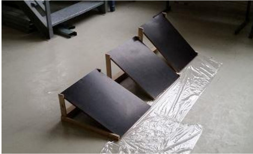
33 pav. Bandymo standai cemento tešlos ir betono mišinio pastovumui ant nuožulnios plokštumos vertinti
