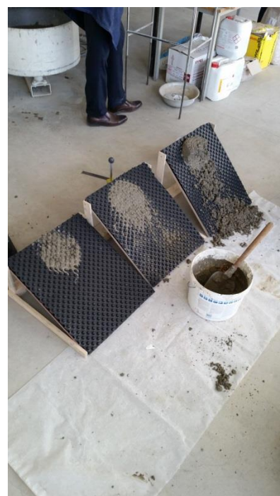
Betono mišinio bandinys, esant plokštumos posvyrio kampui 45°
