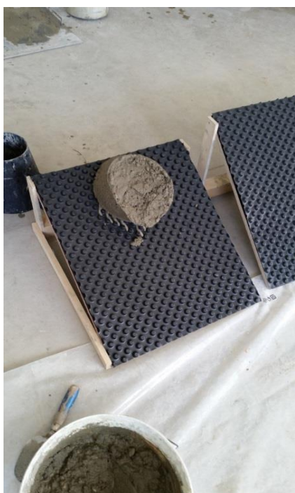
Betono mišinio bandinys, esant plokštumos posvyrio kampui 25°
