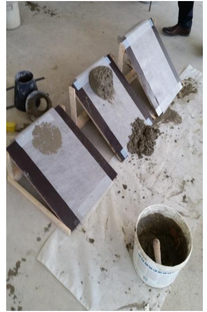
Betono mišinio bandinys, esant plokštumos posvyrio kampui 35°
