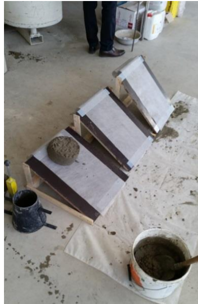
Betono mišinio bandinys, esant plokštumos posvyrio kampui 25°
