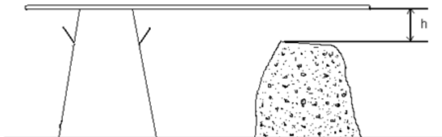
32 pav. Betono mišinio slankumo matavimas
