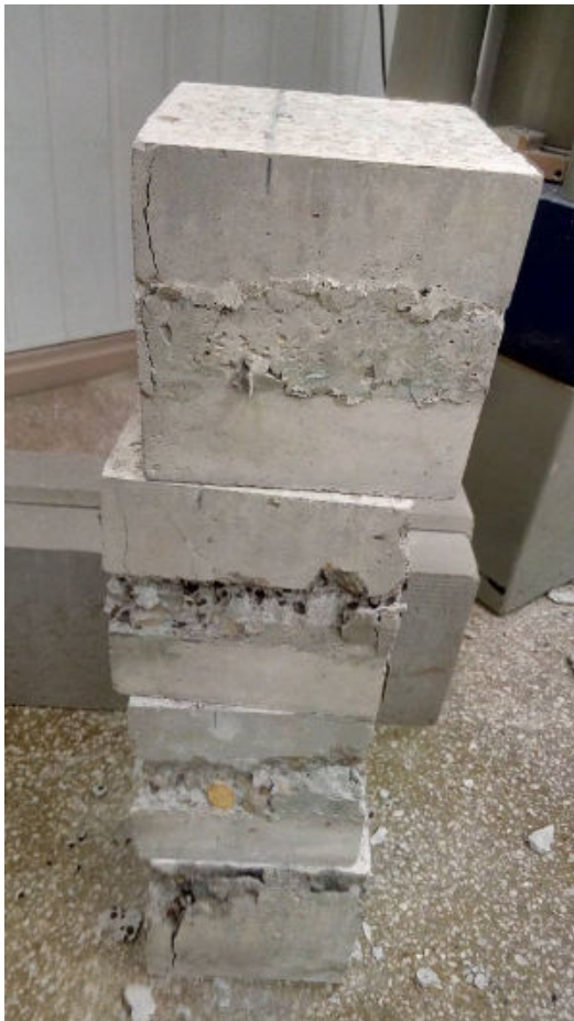
20.pav. Mėginiai po gniuždymo
