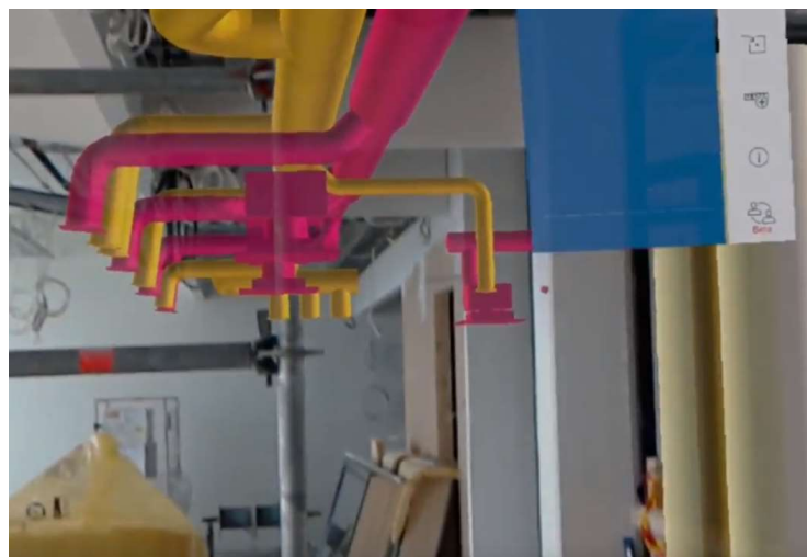
Pav. 13 ŠVOK vamzdynų projekcija papildytoje realybėje. (Microsoft, 2017)
