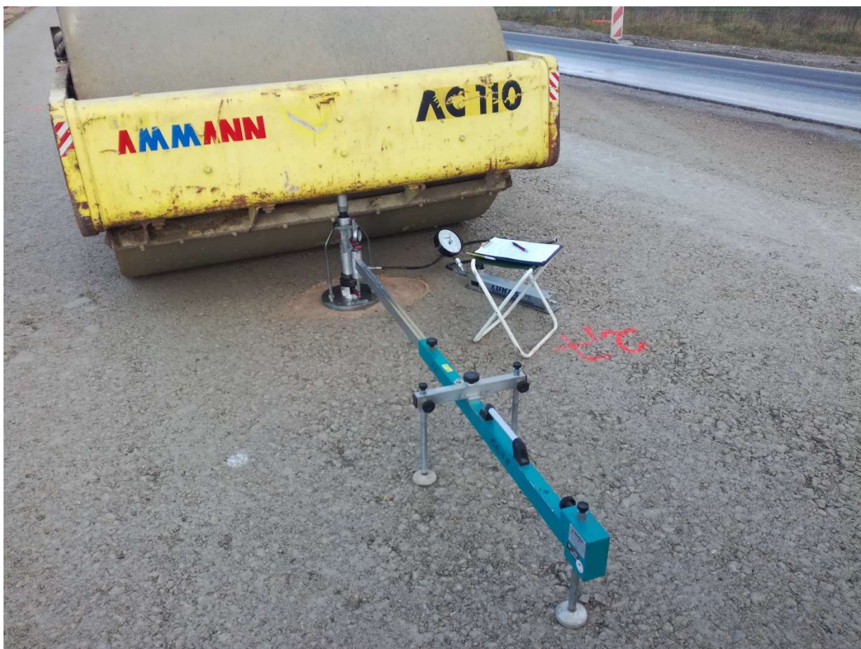
7 pav. Skaldos pagrindo sluoksnio matavimai naudojant statinę sija (štampą)
