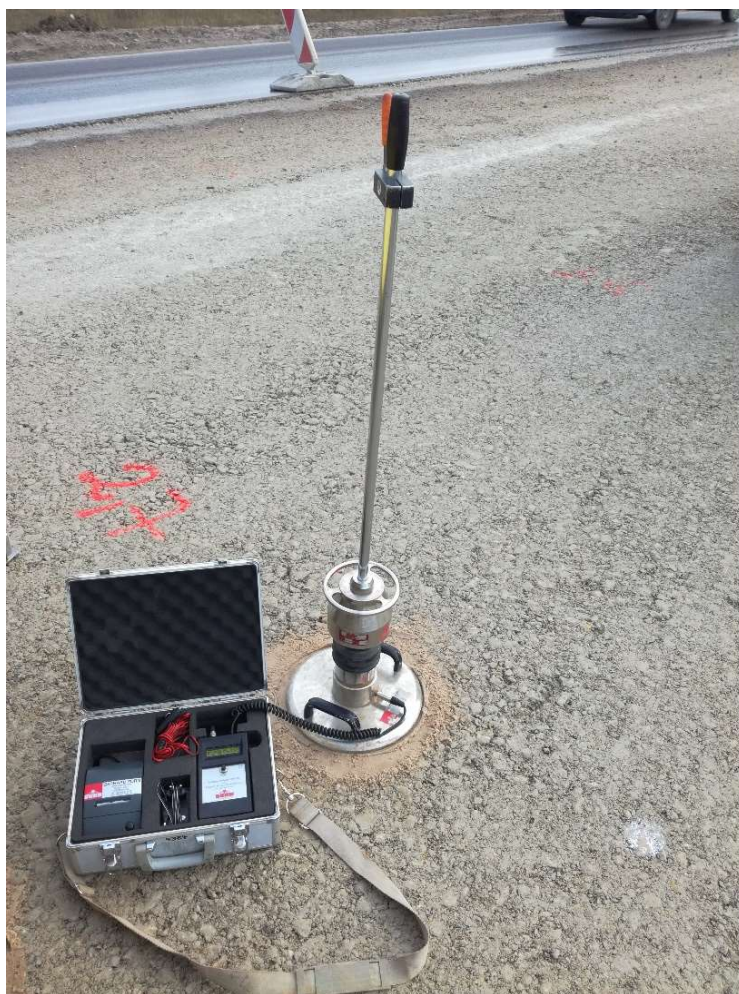
8 pav. Skaldos pagrindo sluoksnio matavimai naudojant dinaminį prietaisą
