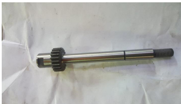
3.4 pav. Pagaminta grežimo galvos ašis iš 40X plieno
