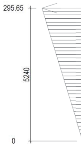
22 pav. lenkimo momento diagramą kolonos ilgiui (lokalioji schema).
