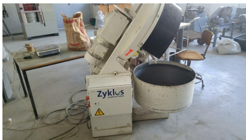
6.2.2.1. pav. Betonų mišinio maišyklė „Zyklos ZZ 50 HE“
