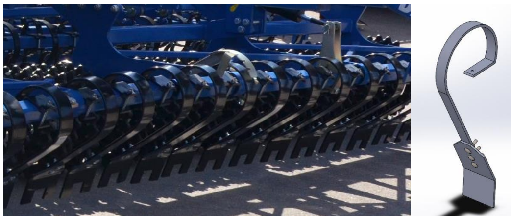
1.6 pav. Segmentinė dantytą lyginimo lenta [iš asmeninio archyvo, AgroBalt 2017] ir nedantytos lentos Solidworks modelis
