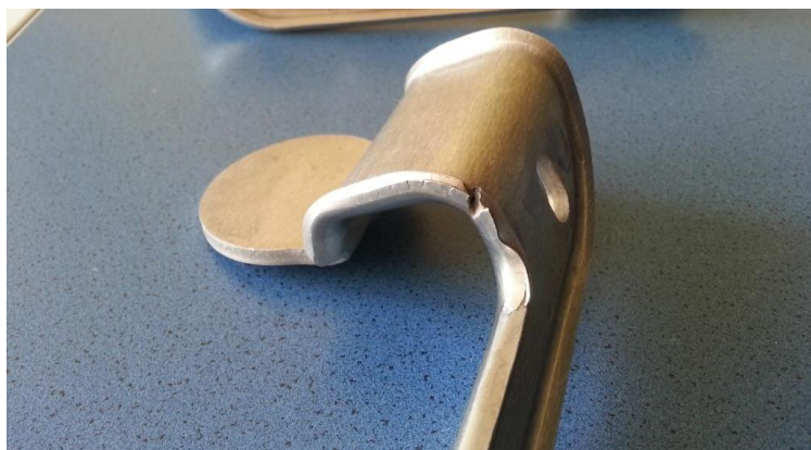
1.5 pav. Detalė su įtrūkimu, atsiradusiu kirštoje briaunoje
