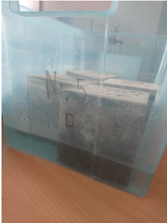
7.12 pav. Betoninių bandinių užpylimų druskos tirpalo aukštis.
