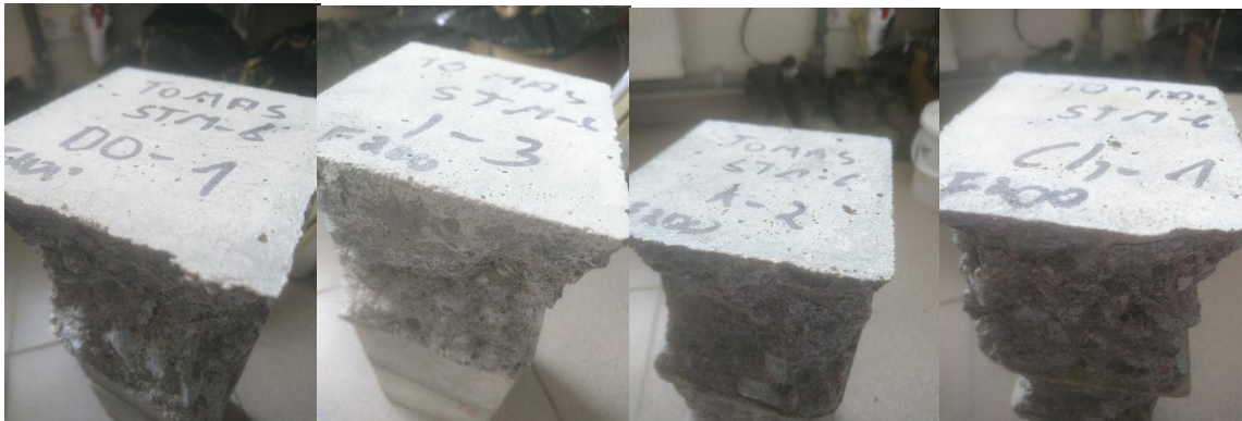
7.17 pav. Sugniuždyti betoniniai bandiniai po 28 parų ir F200 ciklų.
