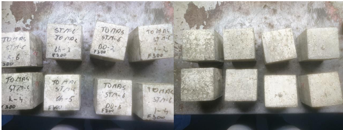
7.19 pav. Bandiniai po 28 parų kietėjimo ir F300 šalčio ciklą.
