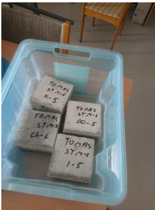
7.11 pav. Betoniniai kubai paruošti paviršiniam šaldymui/šildymui.
