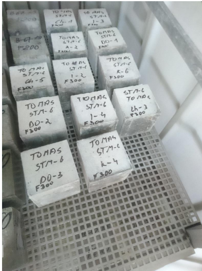
7.15 pav. Betoniniai bandiniai paruošti tūriniam užšaldymui/atšildymui.
