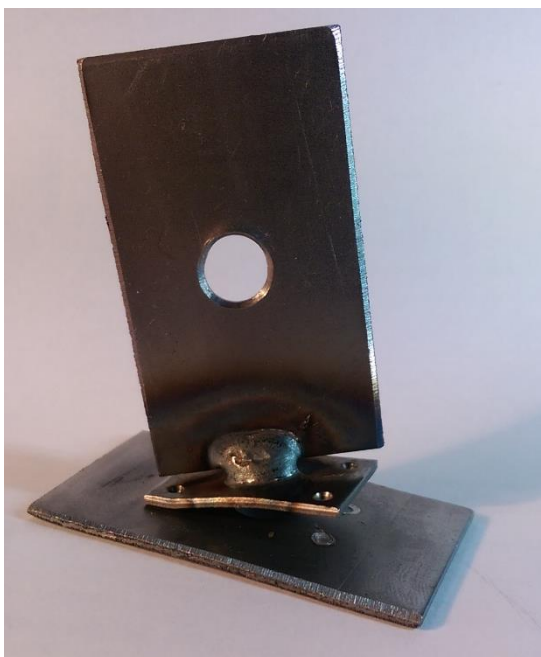
2.9 pav. Deformuotas bandinys po tempimo tyrimo
