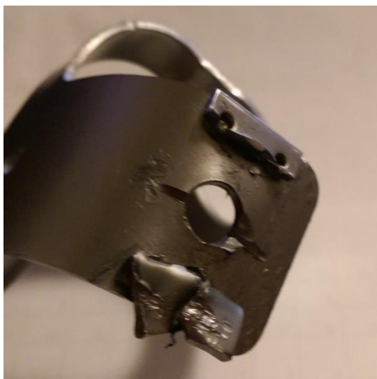
1.9 pav. Privirinto elemento nuplėšimo testas
