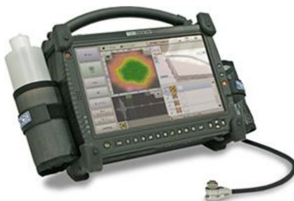
1.5 pav. Ultragarsinis prietaisas suvirintoms veržlėm tikrinti [13]
