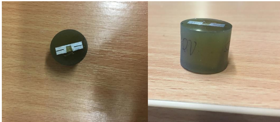
2.7 pav. Aliuminio ruošiniai patalpinti epoksidinėje dervoje
