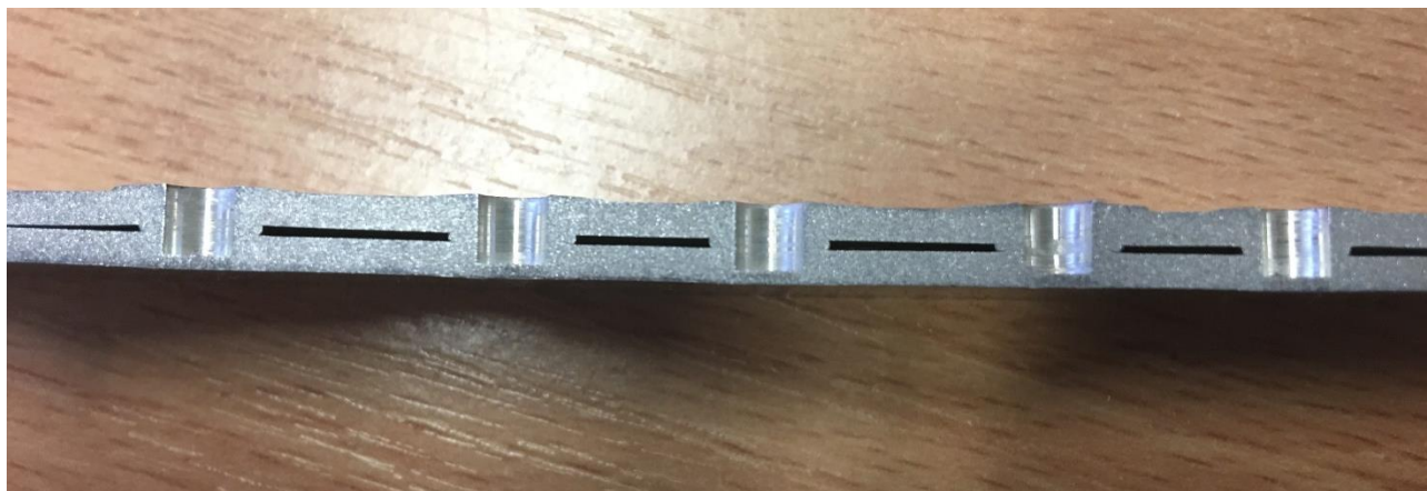
2.6 pav. AlMg3W19 aliuminio ruošinys perpjautas per virinimo taškus su viela, elektroerozinių staklių pagalba
