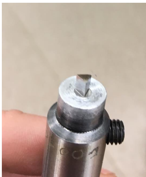
2.4 pav. a) Laikiklis su trikampi profiliu
