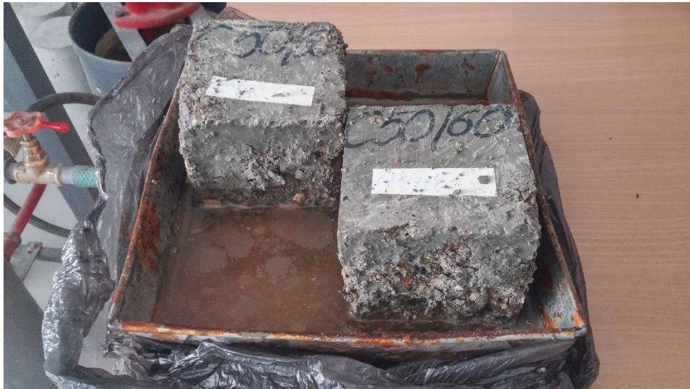
7.17 pav. Bandiniai po 14 užšalimo - atšilimo ciklų paviršinio šaldymo bandymu
