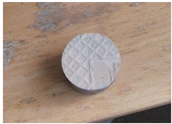
7.10 pav. Atplėšti bandiniai; Kairėje – cementiniai klijai, dešinėje – gipsiniai klijai
