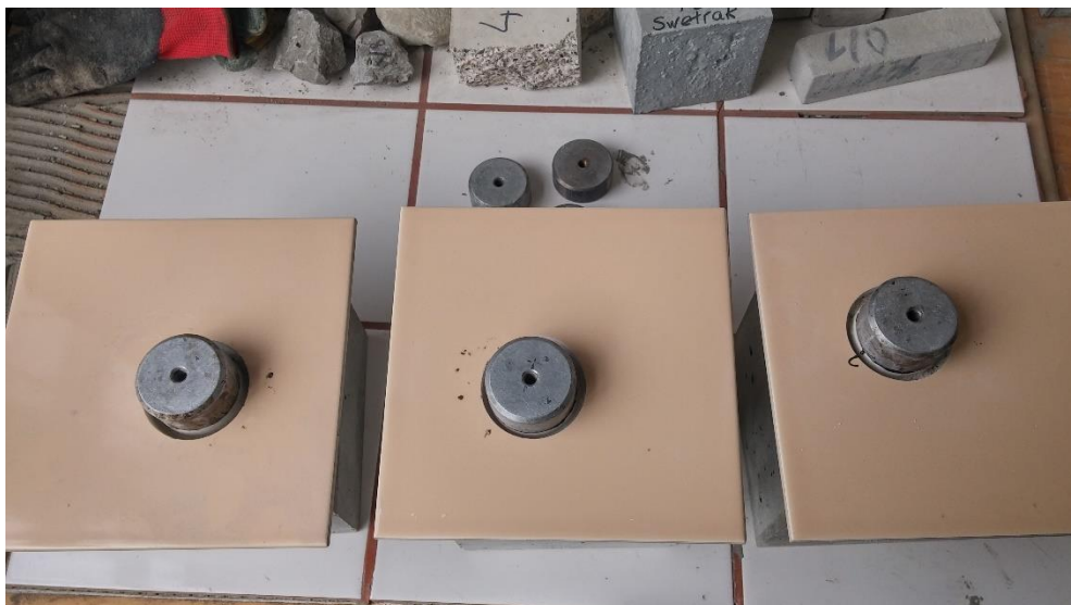
7.8 pav. Įklijuotos prietaiso platformos
