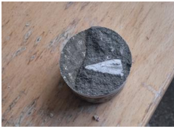
7.10 pav. Atplėšti bandiniai; Kairėje – cementiniai klijai, dešinėje – gipsiniai klijai
