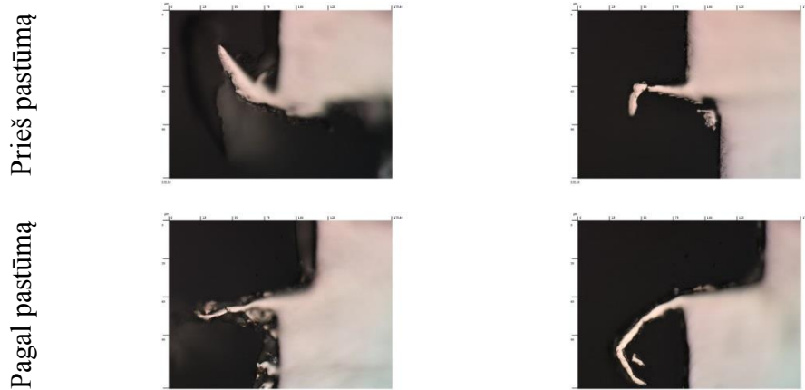
3.3 pav. Didžiausio užvartų aukščio nuotraukos darytos su Sensofar S neox
