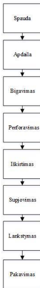
15 pav. Lankstukų (SIMPLE) technologinis gamybos procesas
