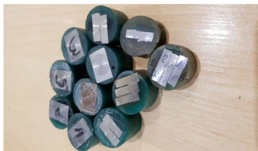
2.9. pav. Dervoje pritvirtinti ruošiniai
