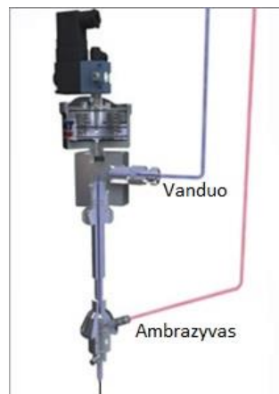
1.9 pav.. Abrazyvinės vandens srovės įpurškimas [16]
