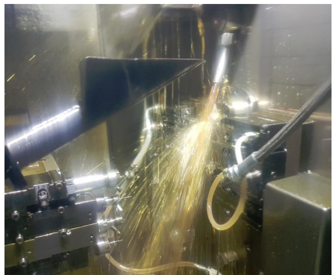
18 pav. Staklių darbinės zonos vaizdas tekimo metu
