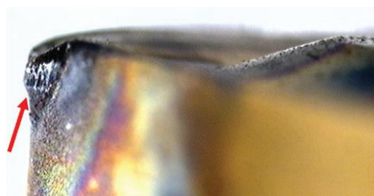
25 pav. Plokštelė su plastine pjaunančiosios briaunos deformacija [28]
