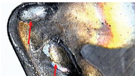
22 pav. Plokštelė su krateriniu nudilimu [28]
