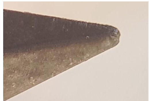
45 pav. Tekinimo plokštelė su plastine deformacija
