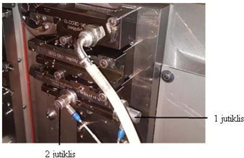
28 pav. Pjezoelektrinių jutiklių pozicijos bandymo metu
