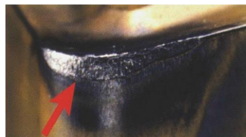
21 pav. Plokštelė su šoniniu nudilimu [28]
