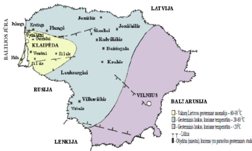
4.3 pav. Lietuvos geoterminio lauko rajonavimas pagal kambro kraigą (Sudaryta pagal LEI, 2007; UAB „AF-Terma“, 2007)
