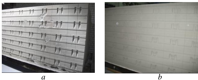
3.5 pav. Supjautų masyvų optinės mikroskopijos nuotraukos esant skirtingam cemento priedo kiekiui, %: a – 13,7; b – 23,6
