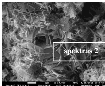
3.35 pav. AAB bandinių, kietintų 16 h 200 °C temperatūroje, SEM nuotraukos
