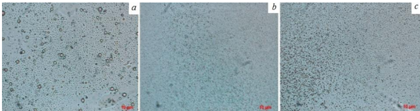
3.9 pav. Mikroskopinės V-A tarpfazio nuotraukos po 24 h laikymo kambario temperatūroje (neveikiant mechanine jėga) esant skirtingam PGPR kiekiui aliejaus fazėje: a – 0 g/100 g, b – 3 g/100 g, c – 6 g/100 g. Vandens ir aliejaus santykis 20:80 (didinimas \times 40 )
