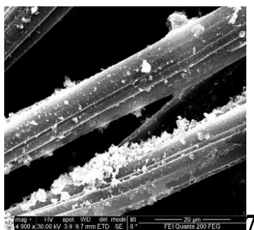
4.19 pav. GV-Co-Ni-ug bandinių, gautų po 10 min (1–4) ir 60 min (5–8) žematemperatūrio cheminio Co-Ni nusodinimo, išorinių (1, 2, 5, 6) ir vidinių (3, 4, 7, 8) siūlelių SEM nuotraukos, gautos esant 4000 (1, 3, 5, 7) ir 30 000 (2, 4, 6, 8) kartų didinimui
