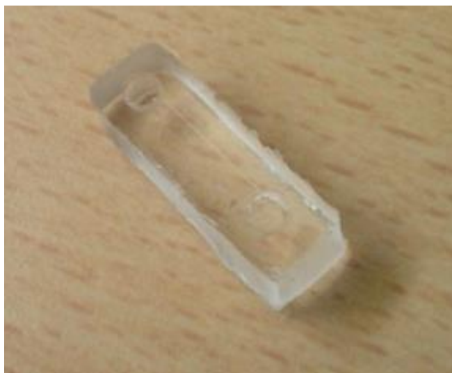
3 pav. PDMS mikrokanalas: a) išorinėje liejimo formoje; b) atskirtas nuo išorinės formos
