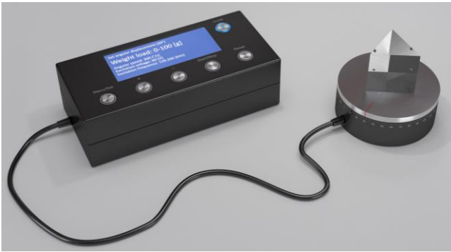
5.1 pav. Geometrinis virtualus veikiančio aukštos skyros pjezoelektrinio sukamojo staliuko su integruota grįžtamojo ryšio valdymo sistema optiniam elementui pozicionuoti prototipo modelis
