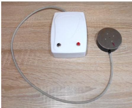
5.2 pav. Fizinis aukštos skyros pjezoelektrinio sukamojo staliuko su integruota grįžtamojo ryšio valdymo sistema prototipas
