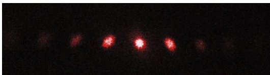
4.7 pav. Polimerinės gardelės tipo skalės difrakcijos intensyvumo vaizdas optiniame ekrane skalę apšviečiant He–Ne lazerio spinduliu
