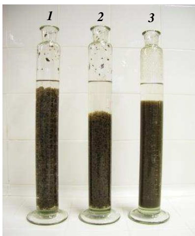
3.42 pav. Tankinto veikliojo perteklinio nuotekų dumblo sedimentacijos nuotrauka po 15 min. naudojant optimalias flokuliavimų dozes: 1 – SKF 2 ; 2 – disperguotas TKK 0,19/0,0005 ; 3 – disperguotas KK 0,19
